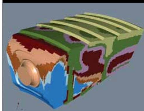
**FIGURE 5 LOCAL DAMKÖHLER NUMBER FOR A SIMPLE WALL JET COMBUSTOR**
